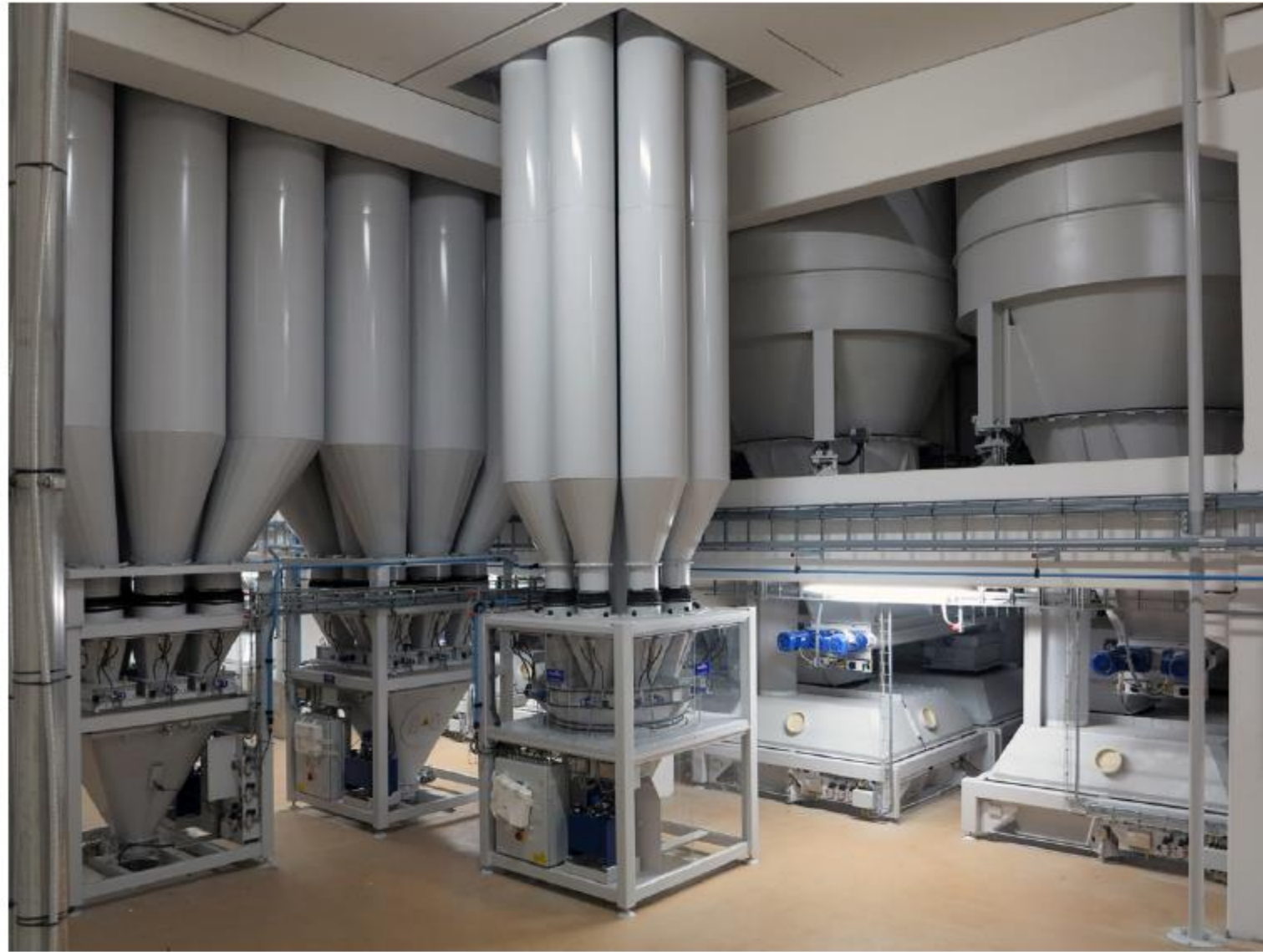
شکل ۵-۵-ب- مخزن بالای میکرو دوزینگ با سطح مقطع دایره (کارخانه کالمار لانتمن ۲ ، سوئد؛ طراحی و ساخت توسط شرکت ون آرسن، هلند، تصویربرداری توسط مؤلف در سال ۱۳۹۶).
