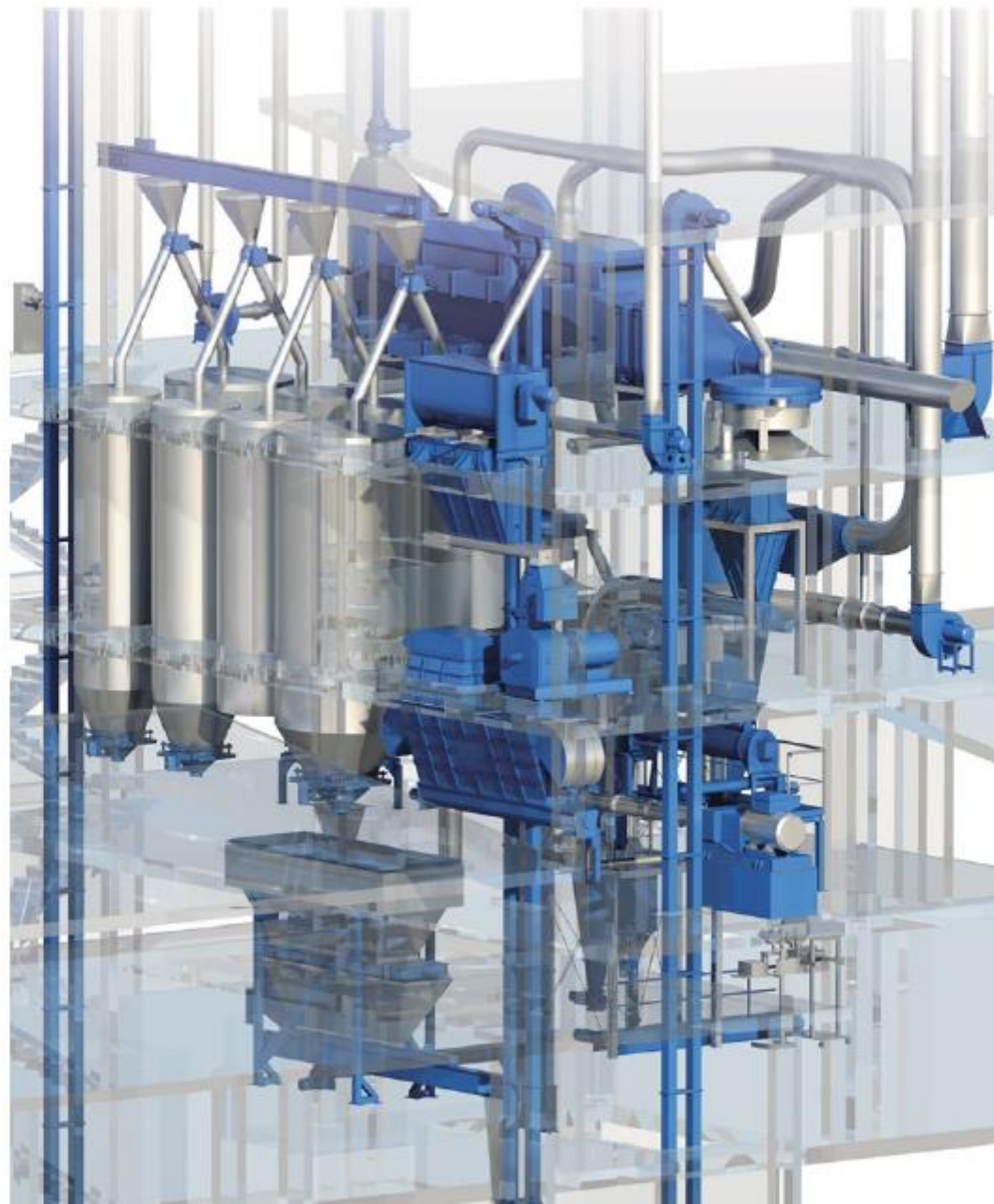
شکل ۵-۵-الف- مخازن اصلی کارخانه با سطح مقطع دایره (طراحی توسط شرکت ون آرسن، هلند).
